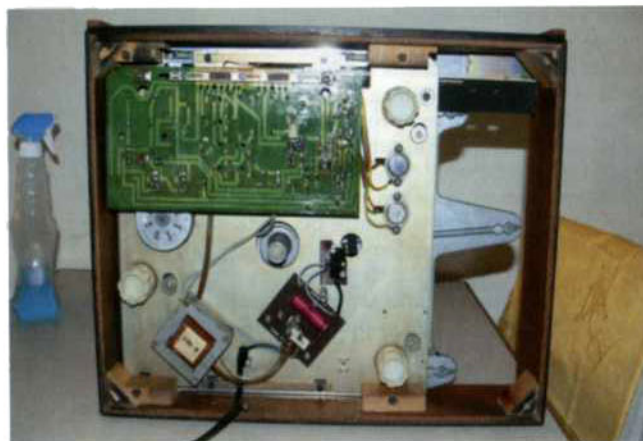
Una foto del TD 125 MK I; da notare i transistor e il motore.
