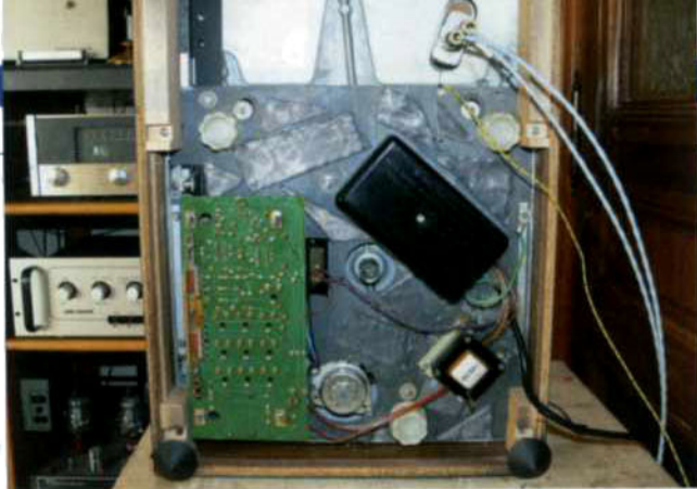
Una visione completa della messa a punto: le già citate quattro punte montate sui blocchetti di legno del telaio, l'antirimbombino in piombo autoadesivo sul controtelaio, la nuova basetta con le femmine RCA per lo SME. Si possono vedere i tre alloggiamenti per le molle, la scheda dell'elettronica e il motore da questa controllato.
