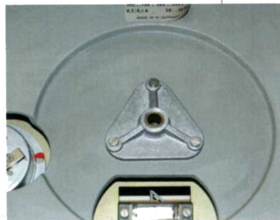
Il pregevole alloggiamento dell'albero del contropiatto del 125 MK I.
