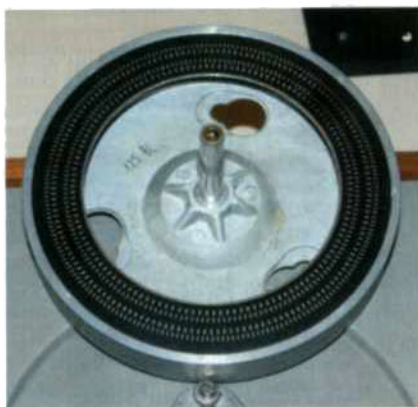
Il contropiatto del Thorens TD 125 MK I con la sfera in acciaio.
