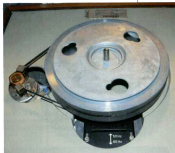
La cinghia, il motore e il contropiatto del Thorens TD 125 MK II.
