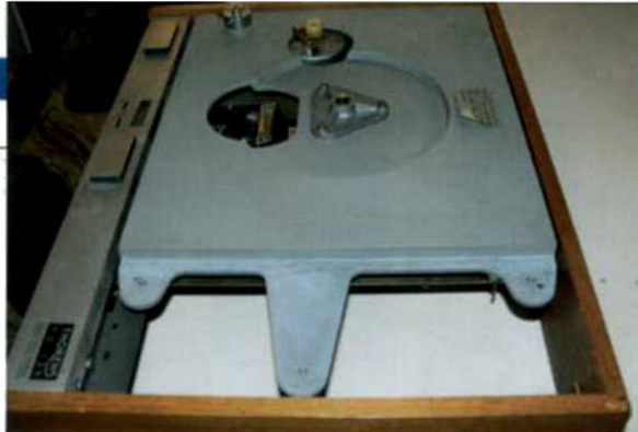
La base in fusione di un TD 125 MK I: controllare sempre che non sia bombata al centro, e lo stesso vale anche per la versione MK II.
